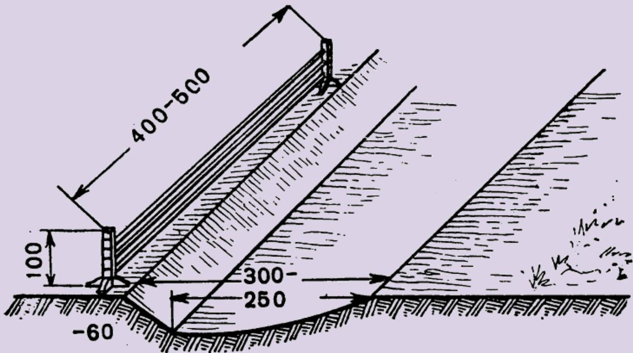
Рис. 120. Канавка с жердевым забором
