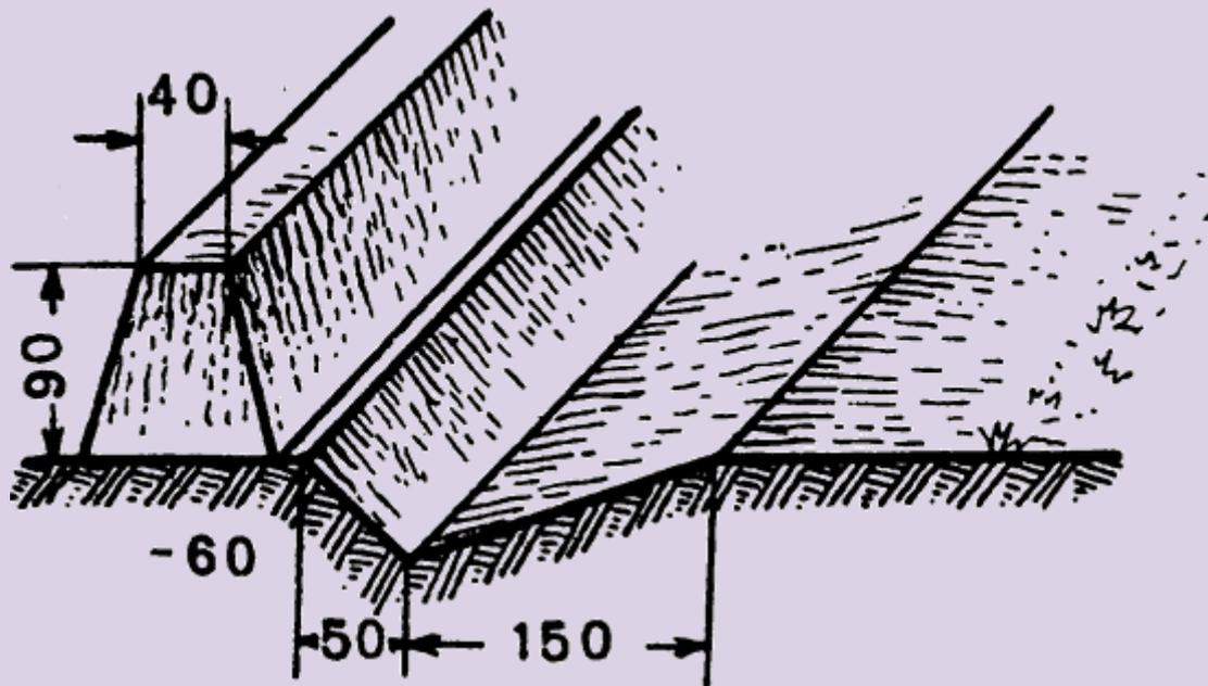
Рис. 121. Канавка с валом
